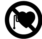
Etäisyys sydämentahdistimiin ja muihin lääketieteellisiin implanteihin pitää olla vähintään 50 cm.
